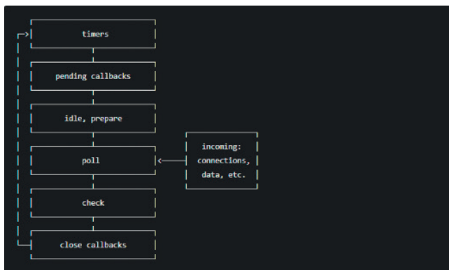
Rysunek 8.1. Pętla zdarzeń Node.js, rysunek zaczerpnięty z dokumentacji Node
